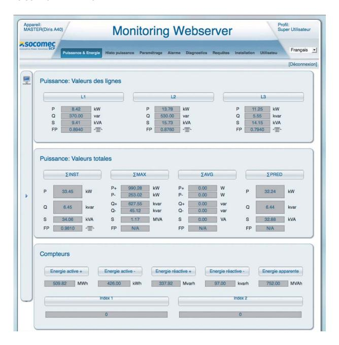
Les énergies consommées instantanées et moyennées sont affichées dans la page **Puissance & Énergie**. Dans le tableau la puissance active P, réactive Q, et apparent S, ainsi que le facteur de puissance FP (caractérisé par le symbole | | | - capacitive ou | - inductive) sont affichées par phase.
