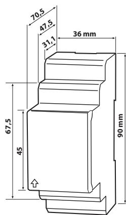
La flèche située à la base du boîtier indique l'endroit où le cache de la face avant peut être ouvert.
