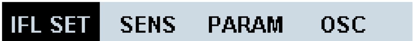
• IFL SET : Permet d'accéder à l'écran des paramètres de calculs de mesure de l'isolement
