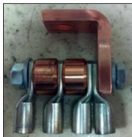
Le raccordement d'un câble aluminium n'est pas possible directement sur la plage de raccordement cuivre. Il est nécessaire d'utiliser une cosse bi-métal pour respecter les couples électrochimiques.
