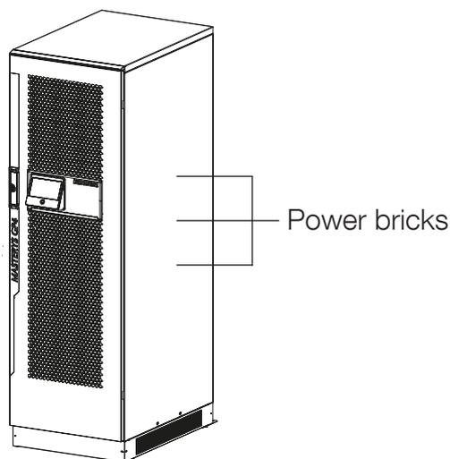
Tout défaut potentiel doit être isolé à l'intérieur des sous-ensembles concernés, en gardant la charge critique protégée en mode double conversion grâce aux convertisseurs de puissance restants afin de maximiser le Temps Moyen entre Pannes Critiques (Mean Time Between Critical Failure).
