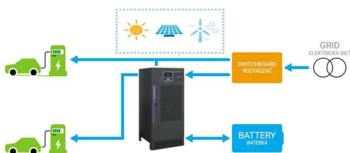
La station de recharge est **connectée à un cloud** hébergeant un algorithme d'écrêtage des pointes permettant de piloter la limitation de la puissance appelée depuis le réseau. Ces premiers projets pilotes ont permis de tester l'ensemble des composantes du projet WATTBOOSTER.
