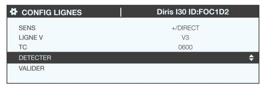
Si une charge est configurée en triphasé ou triphasé+neutre par exemple, il faudra configurer plusieurs capteurs de courant (par exemple 3 capteurs pour une charge triphasée):
