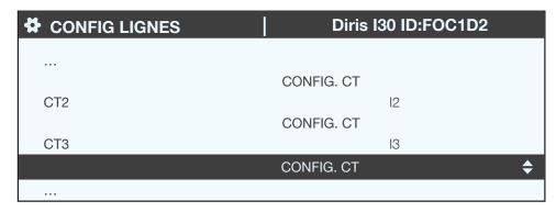
Lorsque l'ensemble de la charge (L1) est configuré (type de charge, nom, courant nominal, ensemble des capteurs configurés), configurer les charges suivantes (L2, L3) depuis la ligne « DEPART »:
