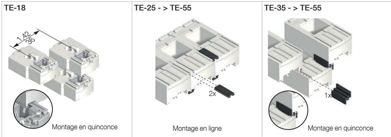
Accessoires de montage pour associer des capteurs :
