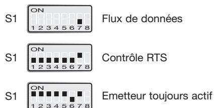
Dans les modes "Contrôle RTS" et "Emetteur toujours actif", les commutateurs pour la configuration du débit des données et pour la sélection du nombre de bits sont sans effets.
