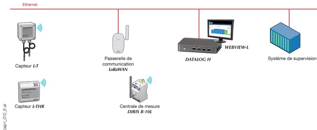
Architecture Cloud – réseau privé avec envoi des données de mesure vers une plateforme Cloud
