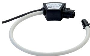
Les capteurs de courants flexibles TF mesurent les courants de charge d'une installation électrique et transmettent l'information aux compteurs et centrales de mesure via une sortie plug and play RJ12. Disposant d'une plage de mesure élargie, les capteurs de courant TF couvrent toute la gamme de courant de 150 à 6000 A grâce à 7 références. Les capteurs de courant flexibles TF sont associables aux DIRIS Digiware, DIRIS A-40 DIRIS B, ou ISOM Digiware F-60 via une connexion rapide RJ12.
