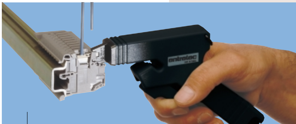
Avec l'outil manuel, l'opération se fait d'un seul geste, sans défaut
