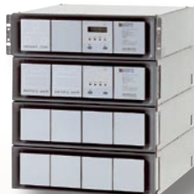
Modulys : une ASI modulaire (installation dans des armoires 19"). Les modules de puissance et d'autonomie peuvent être insérés ou remplacés alors que le système est en fonctionnement (type « Hot swap »).
