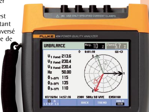
Ecran 1 : visualisation des transitoires sur un réseau Ecran 2 : charge du conducteur neutre au niveau de la 3 e harmonique Ecran 3 (ci-dessous) : exposition d'un déséquilibre dans le réseau
