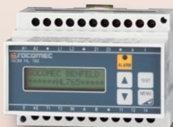
Le contrôleur permanent d'isolement ISOM HL765 est particulièrement adapté à la surveillance des locaux à usage médical : surveillance du niveau d'isolement d'un réseau, du courant de charge et de la température du transformateur de réseau.
