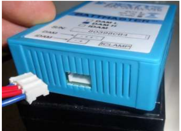
Figure 16 : Connexion du câble au DAM
