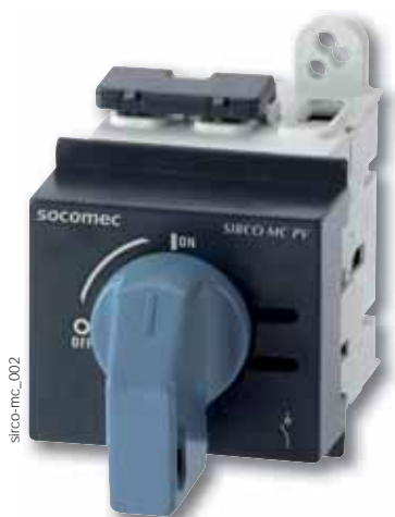
SIRCO MC PV 25 A - 1000 VDC fixation sur rail
