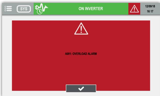
Cliquer sur le bouton de validation pour arrêter le buzzer et fermer la fenêtre de message. Cliquer sur le symbole d'avertissement pour afficher la page des alarmes
