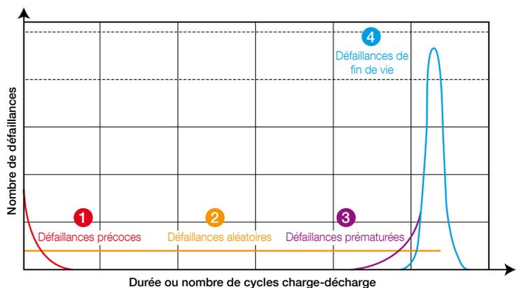
Si le taux de défaillance d'un bloc batterie dépend du nombre d'éléments, la défaillance du moindre bloc d'une chaîne de batteries rend l'intégralité de la chaîne inutilisable ou réduit considérablement le temps d'autonomie disponible. Les autres blocs batteries sont rapidement impactés par l'absence de charge, ou dans de rares cas, par une augmentation du courant de charge, deux scénarii qui peuvent rapidement endommager les autres batteries comprises dans la chaîne.
