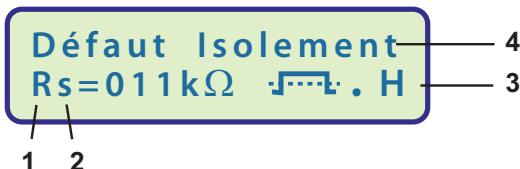
1 Affichage du niveau d'isolement en  $k\Omega$
