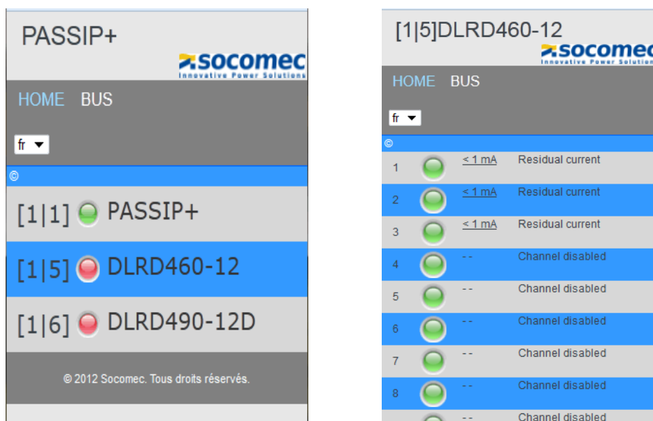
Fig. 8.1: Vue d'ensemble du bus avec liste des appareils et informations sur les canaux
