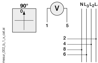
7 positions: mesure phase-phase et phase-neutre (SV7 PL/LN)
