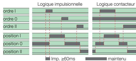
Pour permettre le contrôle, fermer le contact 312 avec le 317. Pour forcer le produit en position O/OFF, fermer le contact 313 avec le 317. Pour sélectionner la logique contacteur, fermer le contact 316 avec le 317. Pour atteindre la position souhaitée, fermer le contact correspondant.
