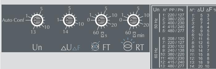
**AVERTISSEMENT !** Quelque soit le réglage du Pot. 1, il faut impérativement régler les Pot. 2 à 4.
