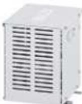
Le transformateur sec type TRM 230/230V est le transformateur BT/BT réalisant la séparation entre le réseau de distribution général et l'alimentation des locaux à usage médical alimentés en régime IT. Il est destiné à l'alimentation d'une salle d'opération ou local d'intervention.
