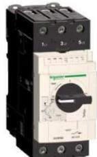
Le circuit alimentant le transformateur de schéma IT médical ne doit pas être protégé contre les surcharges, mais uniquement contre les courts-circuits. Cette fonction est donc réalisée par un disjoncteur type GV2L32. Le contact auxiliaire de défaut de celui-ci est câblé dans la chaîne de défaut générale.
