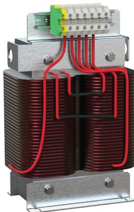
Le transformateur sec type TRM 230/230V est le transformateur BT/BT réalisant la séparation entre le réseau de distribution général et l'alimentation des locaux à usage médical alimentés en régime IT. Il est destiné à l'alimentation d'une salle d'opération ou local d'intervention.
