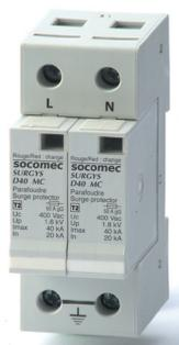
Une option parafoudre peut être rajoutée. Les parafoudres utilisés sont de type SURGYS D40. Cette option assure la protection des circuits de distribution BT et des matériels contre les surtensions transitoires. Il agit contre les surtensions de manœuvres et celles dues à la foudre. Le parafoudre est protégé en amont par des fusibles 50A gG. Le contact de télésignalisation du SURGYS D40 est câblé dans la chaîne de défaut générale.
