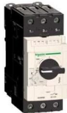
Le circuit alimentant le transformateur de schéma IT médical ne doit pas être protégé contre les surcharges, mais uniquement contre les court-circuit. Cette fonction est donc réalisée par un disjoncteur type GV3L32. Le contact auxiliaire de défaut de celui-ci est câblé dans la chaîne de défaut générale.
