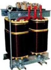
Le transformateur sec type TRM 230/230V est le transformateur BT/BT réalisant la séparation entre le réseau de distribution général et l'alimentation des locaux à usage médical alimentés en régime IT. Il est destiné à l'alimentation d'une salle d'opération ou local d'intervention.
