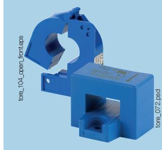
Les capteurs de courant DC mesurent les courants de charge d'une installation électrique en courant continu et transmettent l'information aux modules DIRIS Digiware Idc via une connexion rapide RJ12 facilement repérable par un code couleur.
