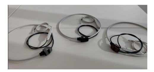
• 3 câbles de raccordement RJ12 de longueur 10m pour augmenter la distance entre les prises courant et la loT PQBox. Là aussi il y a le même code couleur que les prises tension :
